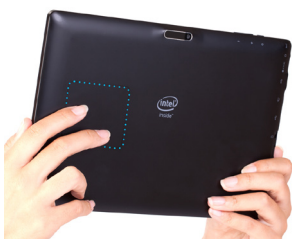
タブレットの背面でカーソルを操作できる「背面タッチパッド」機能
