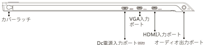
図：On-Lap2501Series 入出力ポートの説明
